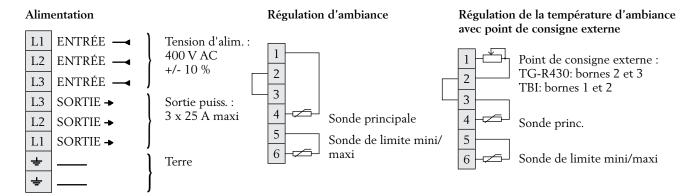
NOTE : avec un raccordement en étoile, la charge doit être symétrique et le neutre ne doit pas être branché !
