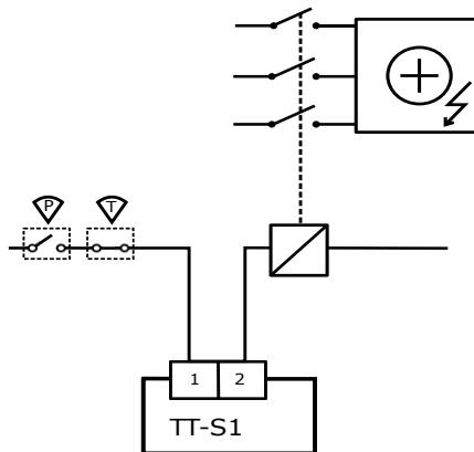
Anschlussbeispiel: Die Zusatzkarte wird mit dem Druckschalter (P), einem Überhitzungsschutz (T) und dem Kontakt eines elektrischen Erhitzers in Reihe geschaltet.
