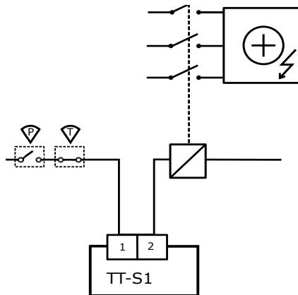
Anslutningsexempel: Slavkortet är kopplat i serie med en tryckvakt (P), ett överhettningsskydd (T) och en kontaktor till en elvärmare.
