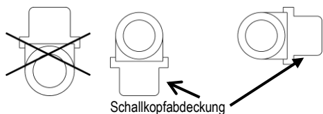
Abb. 4: Empfohlene Einbaulage bei Kältezählung
