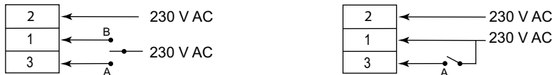
Fig. 4 Vänster = 3-läges; Höger = 2-läges; 1 = Svart; 2 = Vit; 3 = Röd; A = Ställdonsaxeln förlängs; B = Ställdonsaxeln dras tillbaka
