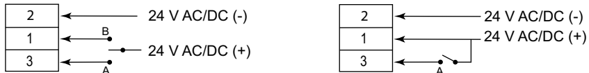
Fig. 3 Vänster = 3-läges; Höger = 2-läges; 1 = Svart; 2 = Vit; 3 = Röd; A = Ställdonsaxeln förlängs; B = Ställdonsaxeln dras tillbaka
