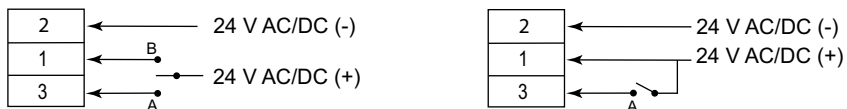
Fig. 3 Gauche = 3 points ; Droite = 2 points ; 1 = Noir ; 2 = Blanc ; 3 = Rouge ; A = Tige d'actionneur sortie ; B = Tige d'actionneur rentrée
