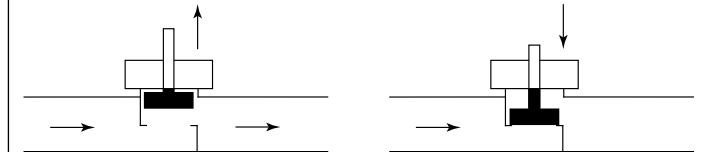
Bild 3 Links: Das Ventil ist geöffnet, wenn die Ventilspindel ausgefahren ist. Rechts: Das Ventil ist geschlossen, wenn die Ventilspindel in das Ventil hineingeschoben ist.
