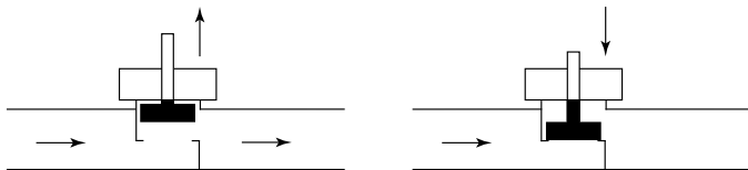
Fig. 3 Gauche : La vanne est ouverte lorsque la tige de la vanne est sortie. Droite : La vanne est fermée lorsque la tige est rentrée.
