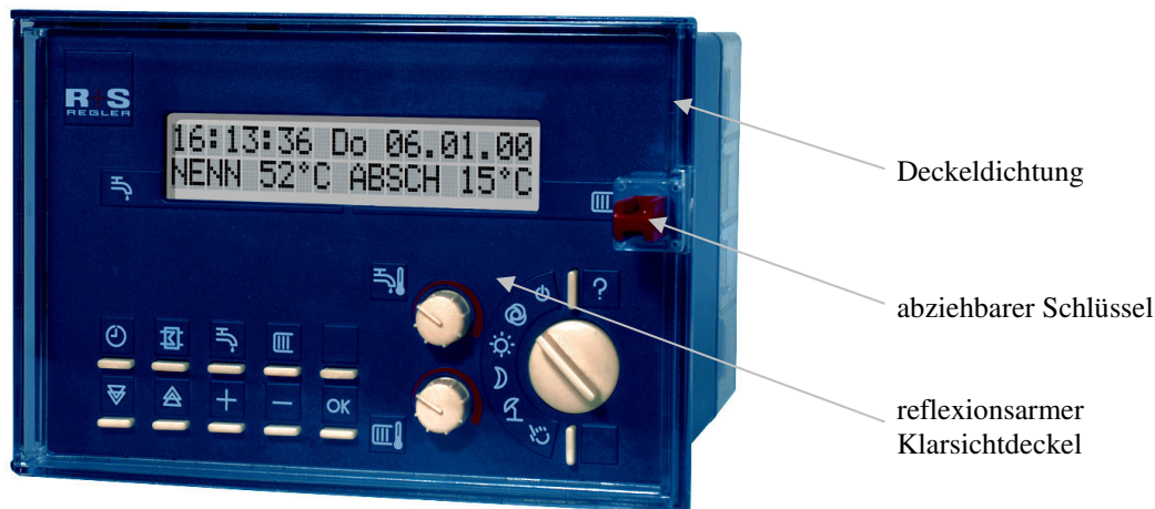
Abb. 1: Frontansicht und Bedienorgane
