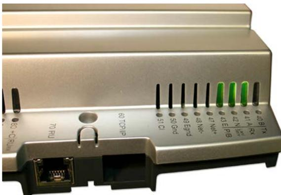
Figure 17. Emplacement des diodes électroluminescente sur le régulateur RCP
