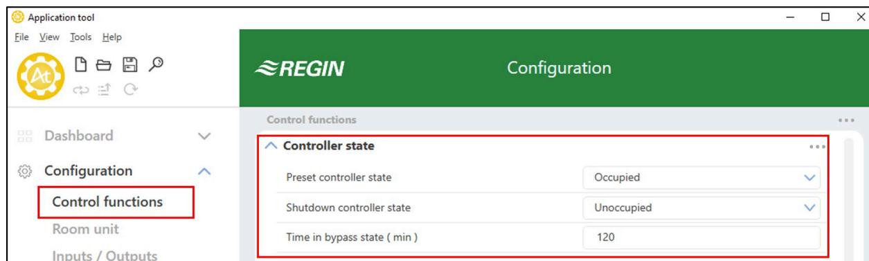
Bild 2-18 Konfigurationseinstellungen des Reglerstatus im Application Tool.
