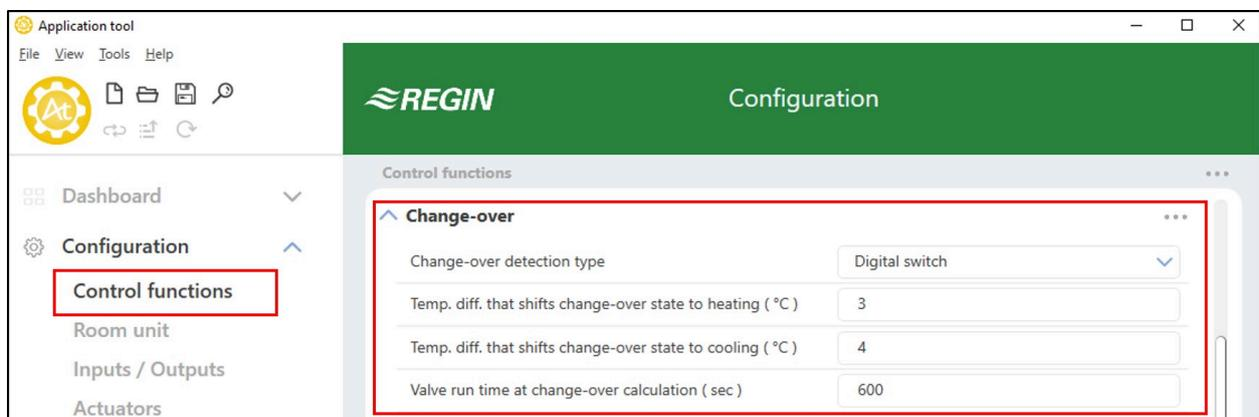
Bild 2-17 Konfigurationseinstellungen der Change-Over-Funktion im Application Tool.
