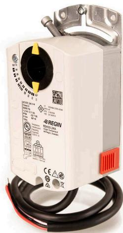
*Klappenstellantrieb ohne Federrücklauf (5 Nm). Für 2-Punkt (Auf/Zu), 3-Punkt oder 0...10 V Stellsignal.*
