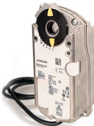
Klappenstellantrieb ohne Federrücklauf (20 Nm). Für 2-Punkt (Auf/Zu), 3-Punkt oder 0...10 V Stellsignal.
