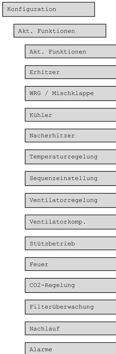
In diesem Bereich werden die Funktionen aktiviert, die im Regler verwendet werden. Hier werden auch die Sequenzen eingerichtet.
