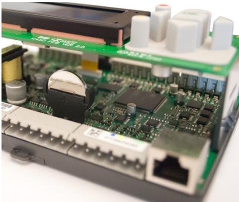
3. Die neue Batterie mit Kraft in die Halterung herunterdrücken.
