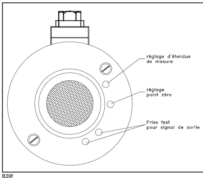
L'appareil de mesure doit avoir été utilisé au moins deux heures avant que le calibrage des capteurs de gaz ne puisse être effectué. Afin de garantir une signalisation en bonne et due forme, les capteurs devraient être montés sous le plafond car l'hydrogène est beaucoup plus léger que l'air. Comme gaz zéro, on utilisera de l'air synthétique ou exempt de H<sub>2</sub>. Comme gaz d'essai, on utilisera une concentration d'au moins 2 % vol. de H<sub>2</sub> dans l'air.
