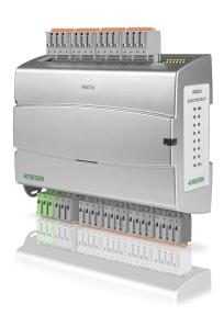
Zusätzliche E/A-Module für EXOcompact und EXOclever mit bis zu 32 zusätzlichen Ein- und Ausgängen je Add:io. Möglichkeit, einen EXOclever mit unbegrenzten Ein- und Ausgängen und einen EXOcompact mit bis zu 50 Ein- und Ausgängen zu erweitern. Die Add:io Module passen problemlos zusammen und benötigen wenig Platz.
