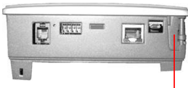
Reiter, um den Regler in der Schaltschranktür zu befestigen
