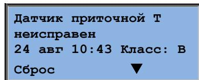
Если зафиксировано несколько аварийных сигналов, это обозначается на дисплее справа стрелками «вверх» и «вниз».
