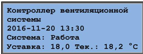
Окно слева, содержание которого обычно отображается при запуске, находится в начале дерева меню. Вид стартового окна может изменяться в зависимости от того, какой из его 5 типов выбран во время конфигурирования. Текст в первой строке может быть изменен с помощью программы E tool<sup>®</sup>.
