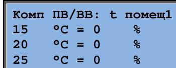
Подменю дополнительной компенсации. Температурно-зависимая компенсация, аналогичная вышеуказанной компенсации, но с выбираемым температурным источником.
