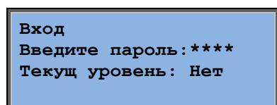
В этом меню можно получить доступ к любому уровню при вводе соответствующего 4-значного кода. Меню входа в систему отобразится также при попытке получения доступа к пункту меню или выполнении действий, требующих более высокого уровня доступа, чем имеющийся.
