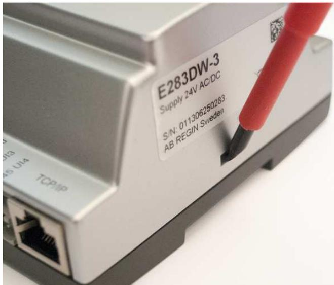
Die Abdeckung wird entfernt, indem mit einem kleinen Schraubenzieher vorsichtig die Hakchen an Rande der Abdeckung eingedruckst und gleichzeitig die Kante der Abdeckung nach auen gezogen wird.
