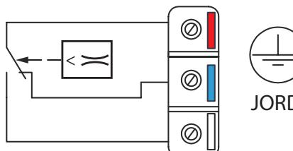
Anslut till de röda och vita kontaktarna på mikrobrytaren. De kommer att öppnas när flödet faller under inställt nivå.
