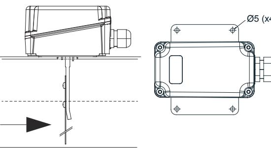
Om röret är vertikalt måste flödesvakten kalibreras om så att skovelns tyngd balanseras.
