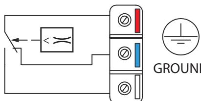
Der Anschluss erfolgt an die roten und weißen Kontakte des Mikroschalters. Sie öffnen sich, sobald der Durchfluss unter den eingestellten Grenzwert fällt.
