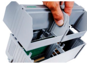
Retirada de la cubierta
