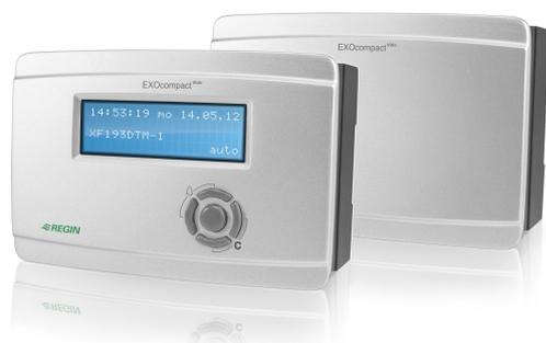
*EXOcompact Vido est un automate librement programmable alimenté en 230 V AC et parfaitement adapté aux applications de chauffage. Il communique nativement via EXOline, Modbus ou BACnet et peut s'intégrer dans un système EXOscada ou d'autres systèmes SCADA. L'automate peut être utilisé comme une unité autonome ou bien intégré dans un système.*
