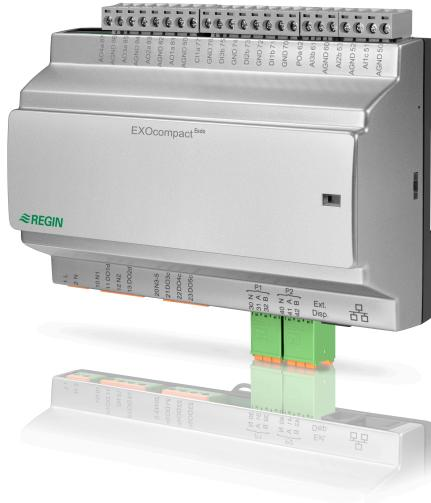
EXOcompact Eedo est un automate d'ambiance librement programmable en 230 V AC. Le régulateur communique via EXOline, Modbus ou BACnet et peut s'intégrer dans un système EXOscada ou d'autres systèmes SCADA. EXOcompact peut être utilisé comme une unité autonome ou bien intégré dans un système. L'automate se connecte automatiquement aux unités d'ambiance Regin, ED-RU.
