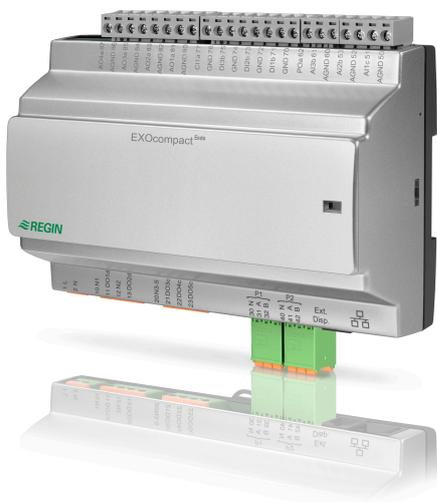
*EXOcompact Eedo ist ein frei programmierbarer Raumregler mit 230V Stromversorgung. Der Regler bietet Kommunikation über EXOline, Modbus oder BACnet für die Einbindung in EXOscada oder in andere SCADA-Systeme. Er kann entweder als Einzelregler (Stand-Alone) oder in einem größeren System verwendet werden. Der Regler verbindet sich fast von selbst mit den Raumfernbedienungen der ED-RU-... Serie von Regin.*
