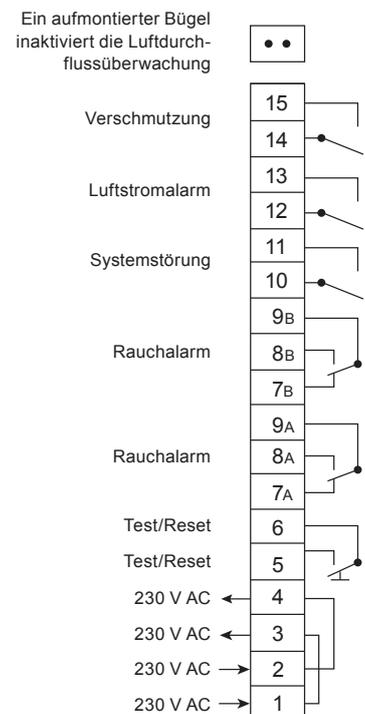
Die Relaisausgänge werden im ausgeschalteten/Alarm-Modus angezeigt.
