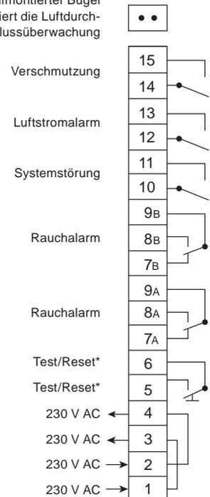
Die Relaisausgänge werden im ausgeschalteten/Alarm-Modus angezeigt.
