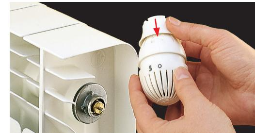
Anslut termostatvredet till ventilen, och se till att ventilstiftet (A), öppningen i termostatvredet (B) och markeringsslinjen (C) är i linje.
