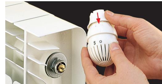
Verbinden Sie den Thermostatkopf mit dem Ventil und stellen Sie sicher, dass die Spindel (A), die Öffnung des Thermostatkopfes (B) und die Kerbe im verbindungsring (C) ausgerichtet sind.
