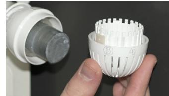
Exempel: Montera begränsaren till vänster om siffran **3**. Detta gör att vredet kan vara helt öppet, eller stängas så långt som till position **3**.
