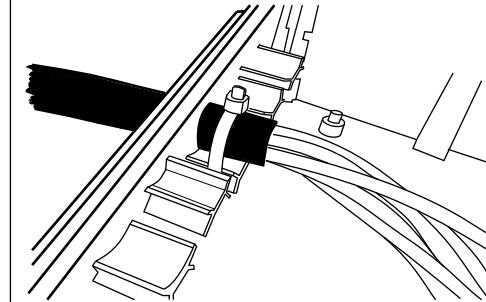
Figure 2 Fastgør kablet med en kabelbinder
