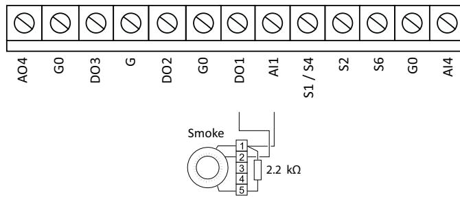
Figure 6 Røgdetektor tilsluttet strøm og analog indgang 1
