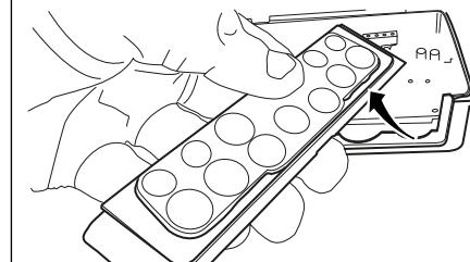
Figure 3 Kabelgennemføringssamlingen kan fjernes fra kabinetet
