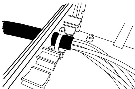
Figur 2 Fäst kabeln med ett buntnet.
