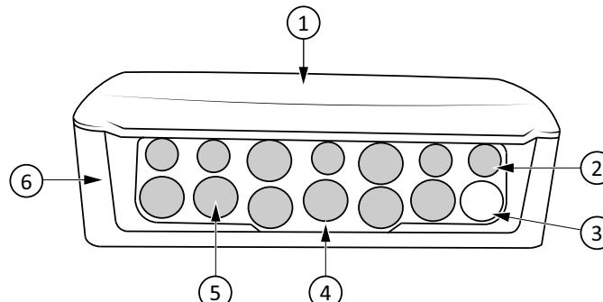
Figure 11: 1: Låg, 2: Kabelgennemføringssamlingen, 3: LED, 4: Kabelgennemføring, 5: Blød del af kabelgennemføring, 6: Kabinet
