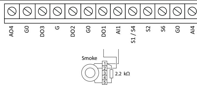
Figur 6 Rökdetectör ansluten till ström och Analog ingång 1
