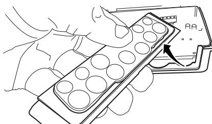
Figur 3 Kabelgenomföringspanel, kan tas bort från kapslingen
