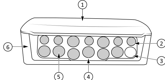
Figur 11: Lock, 2: Kabelföringspanel, 3: LED, 4: Kabelföring, 5: Mjuk del av kabelföring, 6: Kapsling
