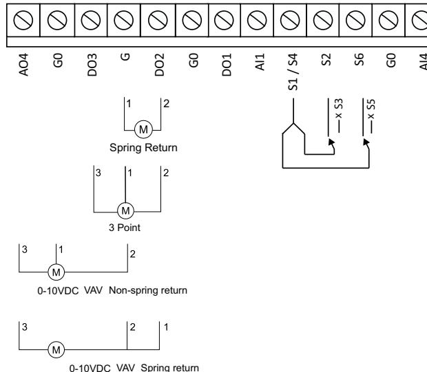
Figur 5 Ställdon och ändlägesbrytare
