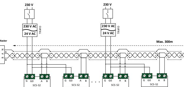
Figure 9 Spjældenheder tilsluttet en masterenhed og ekstern strømforsyning.
