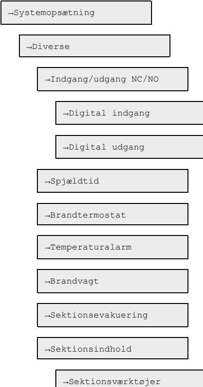
Brug knapperne [OK], [**▶**], [**▼**] og [**▲**] knapper til diverse systemopsætningsfunktioner. Her kan du ændre indgang og udgang (kun visning af værdier), spjældtid, brandtermostat, temperaturalarm (se separat procedure *Indstilling af temperaturalarm for masterenhed*), brandvagt, sektionsevakuering og seksionsindeslutning (se *Sektioner*).
