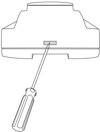
Figure 6 Afmontering af toppen af kabinetet.
