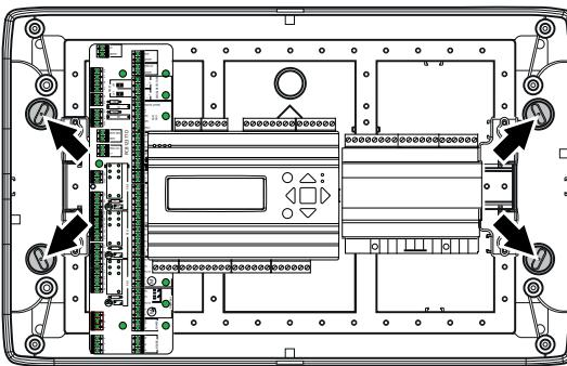
5. Montera tillbaka den översta sektionen i apparatskåpet i omvänt ordning.
