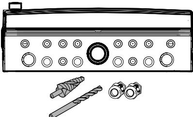
Figur 2 Kabelgenomföringsmallar för apparatskåp
