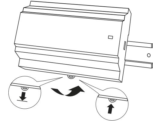
**Figure 5 Afmontering af regulatoren fra DIN-skinnen.**
