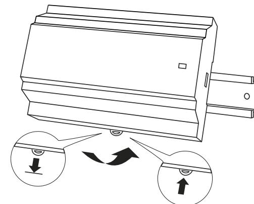
Figur 5 Ta bort regulatorn från DIN-skenan.
