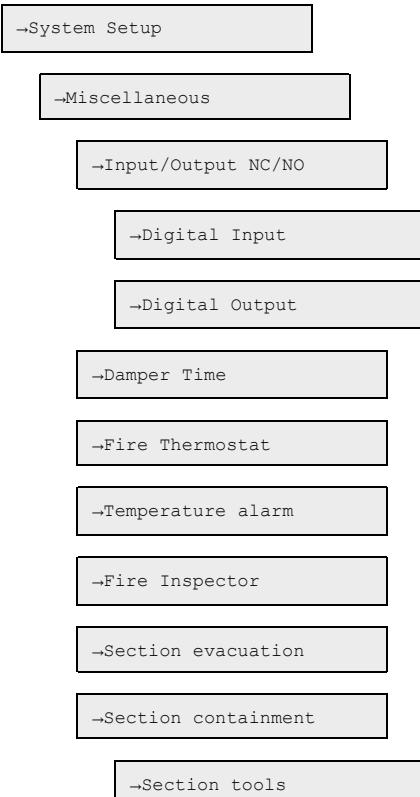
Använd knapparna [OK], [**►**], [**▼**] och [**▲**] för övriga funktioner för systemkonfigurering. Här kan du ändra inmatning och utmatning (endast visning av värden), spjältid, brandtermostat, temperaturlarm (se separat procedur *Ställa temperaturlarm för master-enhet*), brandinspektör, evakuering av sektioner och inneslutning av sektioner (se *Sektioner*).
