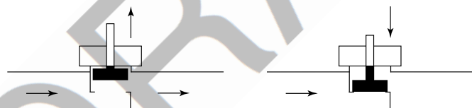
Figur 3 Vänster: Ventilen är öppen när spindeln är förlängd. Höger: Ventilen är stängd när spindeln trycks in i ventilen.
