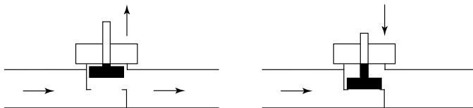
Fig. 3 Gauche : La vanne est ouverte lorsque la tige de la vanne est sortie. Droite : La vanne est fermée lorsque la tige est rentrée.
