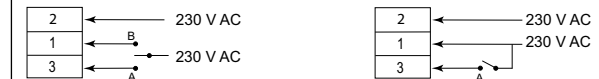
Fig. 2 Gauche = 3 points, Droite = 2 points ; 1 = Noir ; 2 = Blanc ; 3 = Rouge ; A = Tige de l'actionneur sortie ; B = Tige de l'actionneur rentrée
