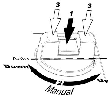
Die Ventilstellung kann manuell eingestellt werden, indem der mittlere Teil des Drehknopfes heruntergedrückt wird, bis er einrastet (1 in der Abbildung). Danach kann die Ventilstellung durch Drehen des Knopfes verstellt werden (2 in der Abbildung). Im Uhrzeigersinn wird die Antriebsstange nach unten, und gegen den Uhrzeigersinn nach oben bewegt.
