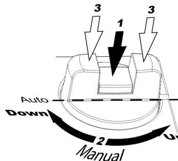
För att manuellt ställa in ventilpositionen, tryck först ned mittenknappen på ratten tills den klickar och stannar kvar i nedtryckt läge (1 i figuren). Ventilpositionen kan då ändras manuellt genom att ratten vrider (2 i figuren). Vid medurs vridning skjuts drivstången utåt och vid moturs vridning dras den inåt.
