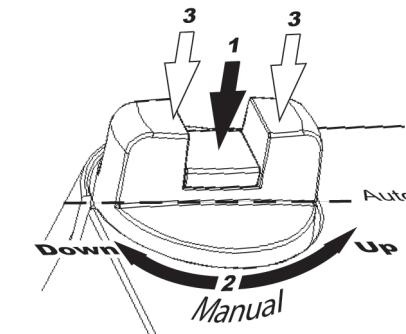
Pour régler manuellement la position de la vanne, appuyez sur la partie centrale du bouton jusqu'à entendre un clic et voir qu'elle reste enfoncée (n°1 sur la figure ci-dessus). La position du boisseau peut ensuite être changée manuellement à l'aide du bouton (n°2 sur la figure ci-dessus). Lorsque vous tournez le bouton dans le sens des aiguilles d'une montre, l'axe sort et lorsque vous tournez dans le sens inverse des aiguilles d'une montre, l'axe rentre.
