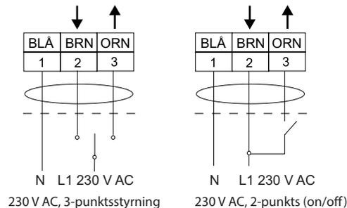
\*\*Ventilerna PCTV, PCTMV och PCTVS DN15-32 är normalt öppna. De stänger när ställdonsspindeln rör sig utåt.
