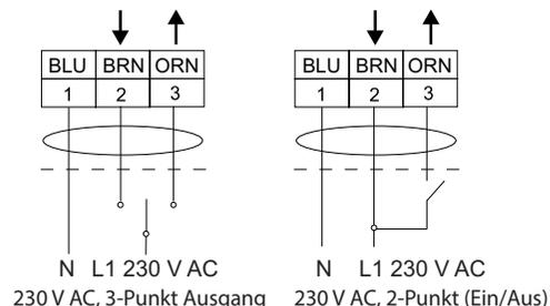
\*\*Die Ventile PCTV, PCTMV und PCTVS DN15–32 sind normal offen. Sie schließen, wenn die Antriebsspindel sich heraus bewegt.
