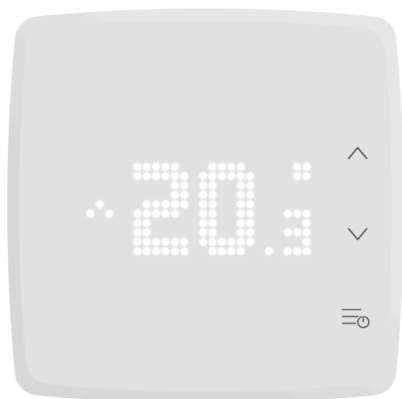
Figur 2-2 Rumsenhetsmodell, med display och knappar
