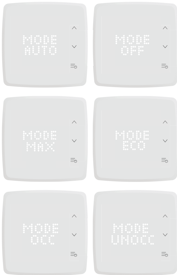
Bild 2-5 Anzeigen im Display des Raumgeräts 3
