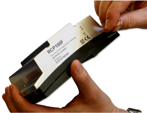
Figur 21. Återställning av programminnet mha resetknappen
