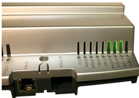
Figur 17. Lysdioder på RCP
