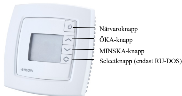
Figur 18. Knappar för displayhantering
