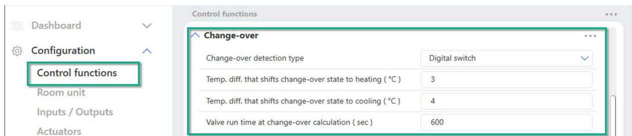
Fig. 2-17 Paramètres de la détection change-over dans Application tool 2
