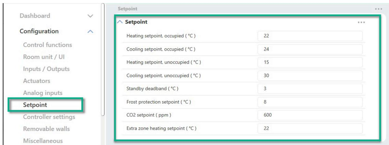
Fig. 5-1 Paramètres de consignes et de zone neutre dans Application tool 2
