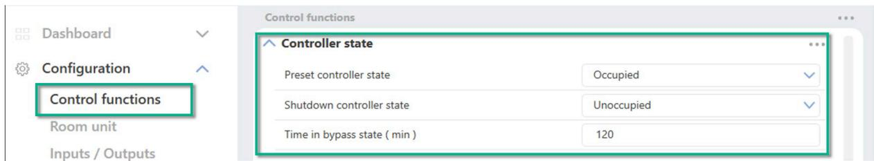
Fig. 2-18 Paramètres de Etat du régulateur dans Application tool 2
