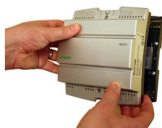
Den modulära uppbyggnaden med separat bottenplatta för kabelanslutningar gör enheterna lätt att installera och driftsätta. Bottenplattan kan sättas på plats innan elektroniken installeras.
