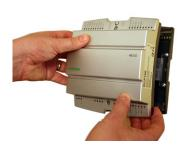
Grâce à leur conception modulaire avec socle et plaque de connexion amovibles, les régulateurs de la gamme RCF sont faciles à installer et à mettre en service. Le socle et la plaque de connexion peuvent être montés avant de procéder à
