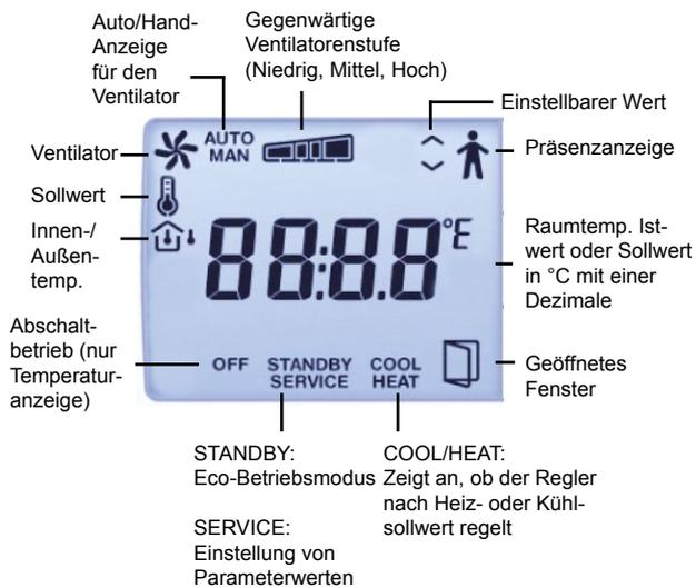
Das Displaymenü wird mithilfe der Tasten am Thermostat bedient:
