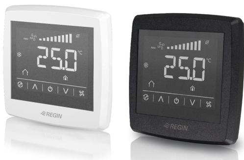
Flach anliegender elektronischer Fan-Coil-Thermostat für die Raumtemperaturregelung. Automatische oder manuelle Umschaltung zwischen Kühlen und Heizen. Der Thermostat besitzt eine dreistufige Ventilatorregelung (für Fan-Coil), einen eingebauten Temperaturfühler, ein hintergrundbeleuchtetes Touch-Display und einen Eingang für eine Hotel-Key-Card oder Präsenzmelder.
