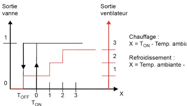
Quand la commande du ventilateur est sur Auto mais qu'il n'y a aucune demande de chauffage ou de refroidissement, le ventilateur tourne en vitesse lente. Ce réglage peut être modifié de sorte à ce que le ventilateur s'arrête lorsqu'il n'y a pas de besoin en chauffage ou en refroidissement. Le ventilateur est inactif en mode Arrêt et en mode Fenêtre. Il continuera cependant à fonctionner si la protection anti-moisissure a été configurée.
