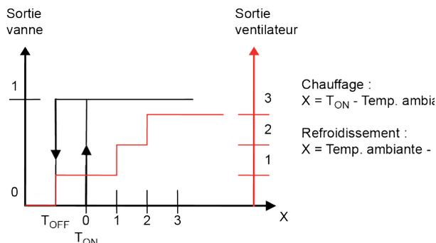
Quand la commande du ventilateur est sur Auto mais qu'il n'y a aucune demande de chauffage ou de refroidissement, le ventilateur tourne en vitesse lente. Ce réglage peut être modifié de sorte à ce que le ventilateur s'arrête lorsqu'il n'y a pas de besoin en chauffage ou en refroidissement. Le ventilateur est inactif en mode Arrêt et en mode Fenêtre. Il continuera cependant à fonctionner si la protection anti-moisissure a été configurée.
