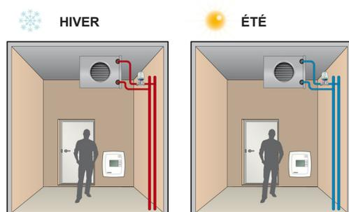
Dans les installations à 4 tubes, il existe deux réseaux indépendants, l'un pour le chauffage et l'autre pour le refroidissement, avec chacun leur vanne de régulation. Le thermostat utilise alors deux sorties pour contrôler le chauffage et le refroidissement en séquence.
