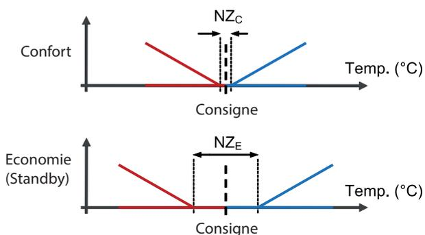
Le schéma ci-dessus présente les conditions nécessaires à l'activation des différents modes de régulation. Ces conditions sont recalculées par le régulateur pour indiquer une valeur à la sortie de l'actionneur, selon la fonction de sortie sélectionnée.
