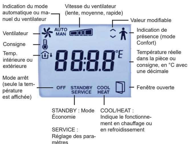
Les boutons en façade de l'appareil permettent de configurer le régulateur :
