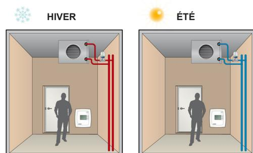
Dans les installations à 4 tubes, il existe deux réseaux indépendants, l'un pour le chauffage et l'autre pour le refroidissement, avec chacun leur vanne de régulation. Le régulateur utilise alors deux sorties pour contrôler le chauffage et le refroidissement en séquence.
