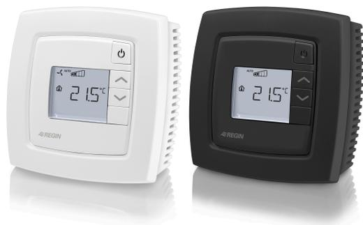
*RCC-C3DOCS... ist ein vorprogrammierter Einzelraumregler aus der Regio Midi Reihe, vorgesehen für die CO<sub>2</sub>-, Kühl- und Heizonenregelung. Es hat einen integrierten CO<sub>2</sub>-Fühler und Kommunikation über Modbus, BACnet oder EXOline zur einfachen Integration in ein System.*
