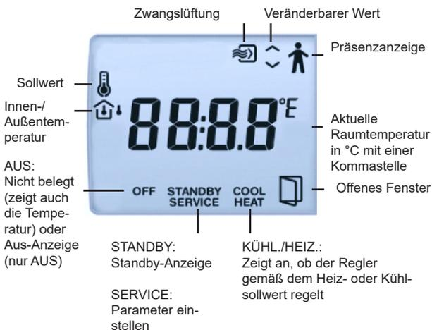
Mit Hilfe der Bedientasten können über das Display verschiedene Werte im Parametermenü eingestellt werden. Die Parameterwerte werden mit den ERHÖHEN- und SENKEN-Tasten geändert und danach durch Drücken der Präsenztaste bestätigt.
