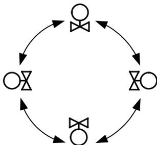
Nach dem Einschalten kalibriert sich der Stellantrieb automatisch, um den Schließpunkt des Ventils zu bestimmen. Bitte rufen Sie bei der ersten Inbetriebnahme
