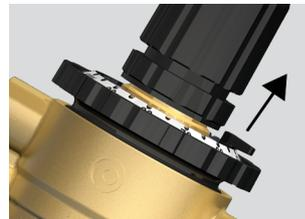
Bild 5 Ziehen Sie den Verriegelungsstift heraus, um den Auswahlkranz zu entriegeln.
