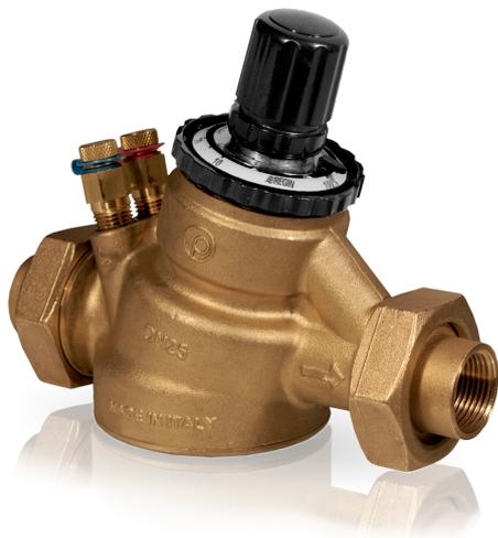
Die PCMTV-Ventile sind für den Einsatz in Fan-Coil-Geräten, Lüftungsanlagen, Kühlbalken usw. geeignet. Sie können als Durchflussbegrenzer in konstanten Volumenstromsystemen (ohne Stellantrieb) oder als tatsächliche PICV in variablen Volumenstromsystemen (mit Stellantrieb) eingesetzt werden.
