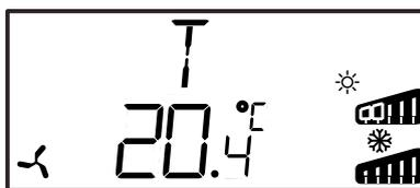
La ligne supérieure indique le mode de régulation sélectionné, soit ici le mode 1: régulation de la température. La ligne inférieure affiche la valeur réelle. Les histogrammes indiquent les niveaux de sortie actuels. En mode 1, divers symboles indiquent comment les sorties sont configurées: chauffage, refroidissement, registre ou basculement (« Change-over »).
