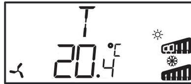
Die obere Reihe zeigt an, welcher Regelmodus konfiguriert wurde, in diesem Fall Regelmodus 1 - Temperaturregelung, die untere Reihe zeigt den Istwert. Die Säulendiagramme zeigen die aktuellen Ausgangsleistungen. Im Regelmodus 1 zeigen Symbole, wie die Ausgänge konfiguriert wurden (Heizung, Kühlung, Klappen oder Change-over).
