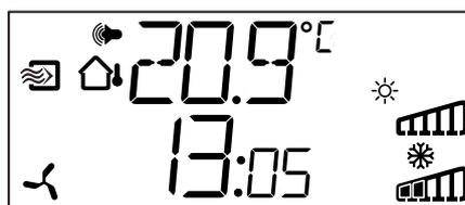
L'heure et la consigne réelle sont affichés ainsi que des diagrammes en bâtons qui indiquent le niveau actuel des sorties. Les symboles correspondants aux différentes configurations des sorties (chauffage, refroidissement, registre, etc.) sont également affichés.
