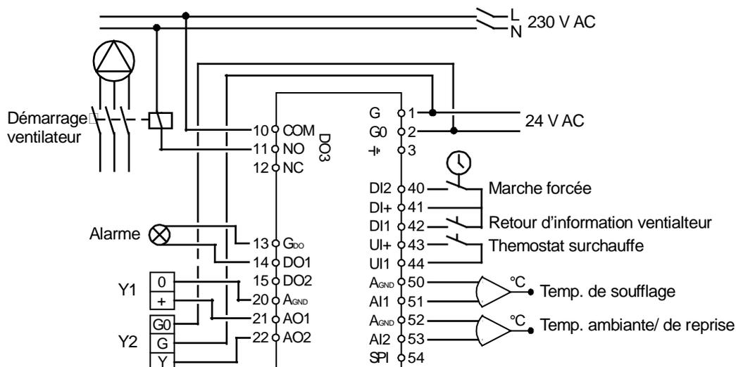
**B. OP10-230 pour batterie de chauffage à eau , sortie 3 points. Régulation du soufflage avec compensation de la température extérieure et potentiomètre de consigne externe.**
