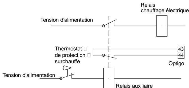
*Exemple de raccordement électrique pour la protection surchauffe lors de l'utilisation du chauffage électrique. Sur cette illustration, la protection contre la surchauffe est représentée active.*
