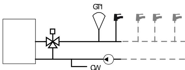
Avec ce mode de régulation il n'y a besoin que d'une sonde « Température ECS » raccordée à AI1.
