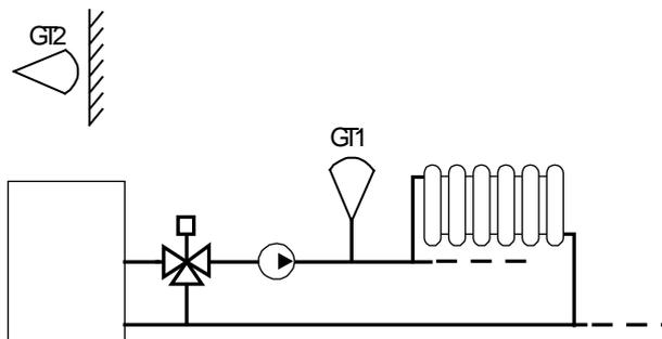
Avec ce mode de régulation il faut deux sondes, GT1 « température de l'eau de départ » branchée sur AI1 et GT2 « Sonde extérieure » raccordée à AI2.
