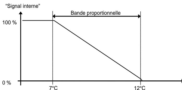
Le signal de protection contre le gel (« Signal interne ») augmente linéairement jusqu'à atteindre 100 % pour une température de 7 °C, soit la valeur à laquelle l'alarme de protection contre le gel est déclenchée. Le ventilateur est alors arrêté et le régulateur passe en mode veille.
