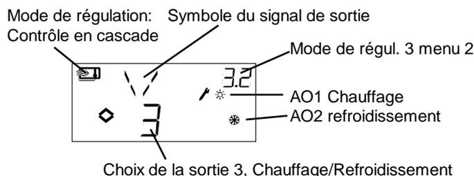
*Exemple de menu X.2 : Régulation de la température ambiante (contrôle en cascade) avec la configuration n°3 : Chauffage/Refroidissement.*
